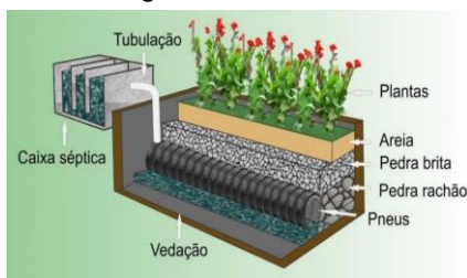
Figura 8 – Sistema de tratamento de esgoto modelo BET
