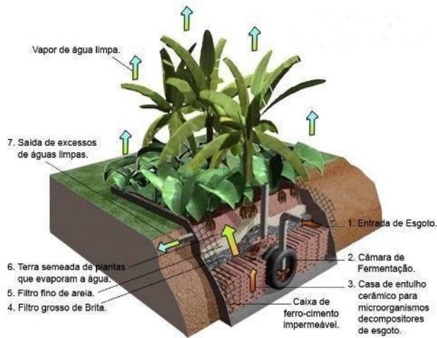
Figura1 – Esquema representativo de uma Bacia de Evapotranspiração.
