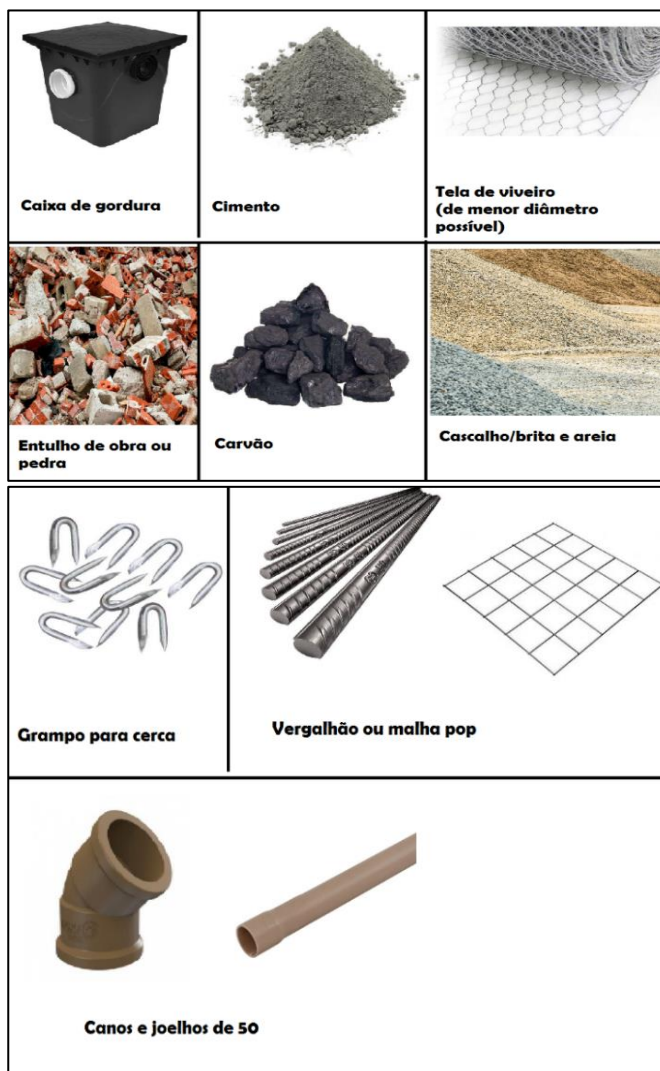
Figura 4 – Materiais para a montagem do filtro biológico
