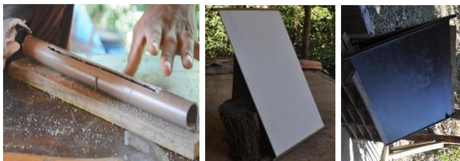
Figura 11 – corte no cano PVC, placa encaixada no PVC e placa pintada de preto
