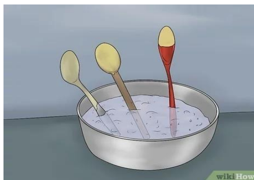
Figura 09 – Esquema para o experimento ilustrativo: condução de calor
