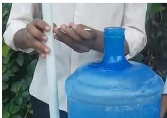
Figura 5 – Cortando o cano PVC
