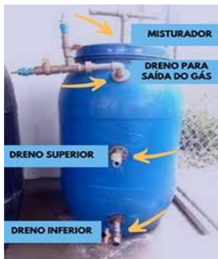
Figura 20 – esquema representativo do biodigestor caseiro
