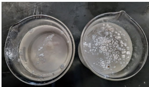
Figura 3. Experimento com talco em amostra de água que demonstra a existência da tensão superficial da água e sua quebra na presença de detergente.
