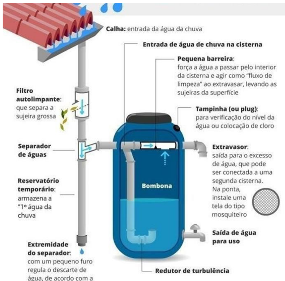
Figura 4. Esquema do Sistema de Captação de Água de Chuva (Fonte: Calvão e Allain, 2021).
