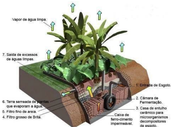
Figura 1. Esquema representativo da Bacia de Evapotranspiração (Fonte: Calvão e Allain, 2021).
